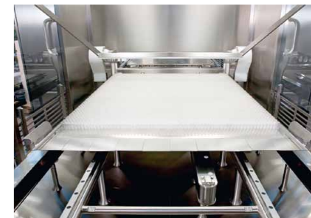
Die „Tischplatte“ nimmt tausende Medikamentenfläschchen auf. So gelangen sie in oder aus dem Gefrier Trockner. Dabei ist die Baugruppe „Transfer Cart“ die zentrale Komponente beim Entladen und dem Transport zum nächsten Prozessschritt.
